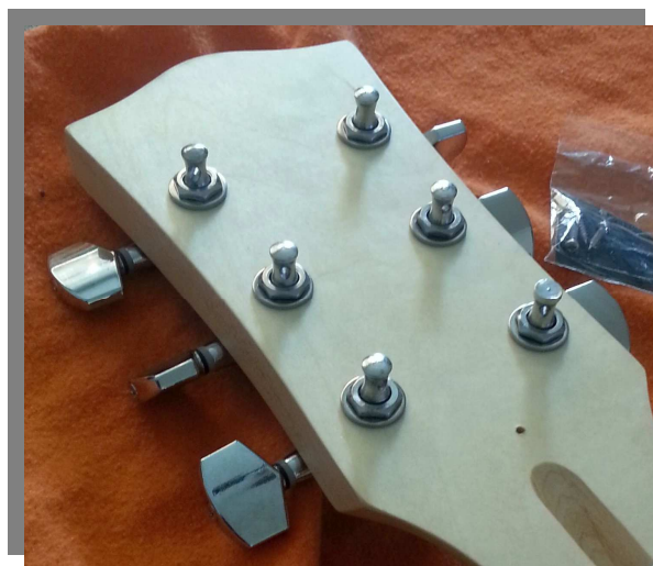
Vorne werden dann die Zentrierungen eingeschraubt. In dem Loch befindet sich die schraube zum Einstellen des Spannstabes
