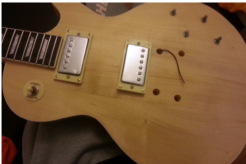
Zu sehen jetzt hier die fertig verdrahtete Elektronik. Hals und Steg Pickups, 3 Wege Schalter und die 4 Potis. Das schwarze Kabel dient zur Erdung
